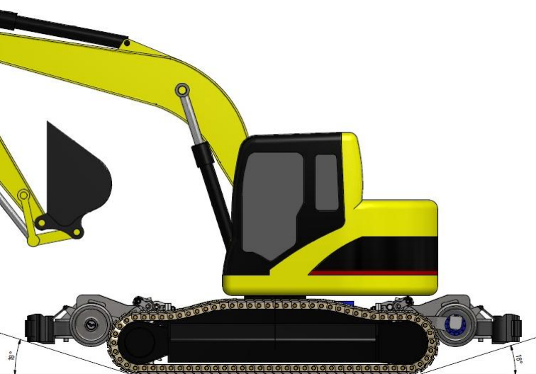
Vista lateral do VRF04-SM (detalhe dos ângulos de entrada e saída)
