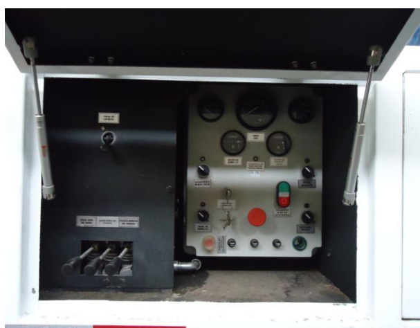
Painel de operação do conjunto de limpeza de bueiros
