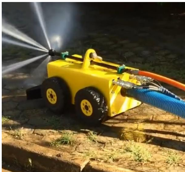
Mini-robô para auxílio a operações em galerias de difícil acesso
